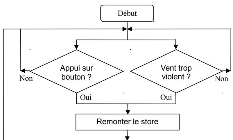
En mettant les deux tests à coté, on réalise la fonction « **OU** ».
